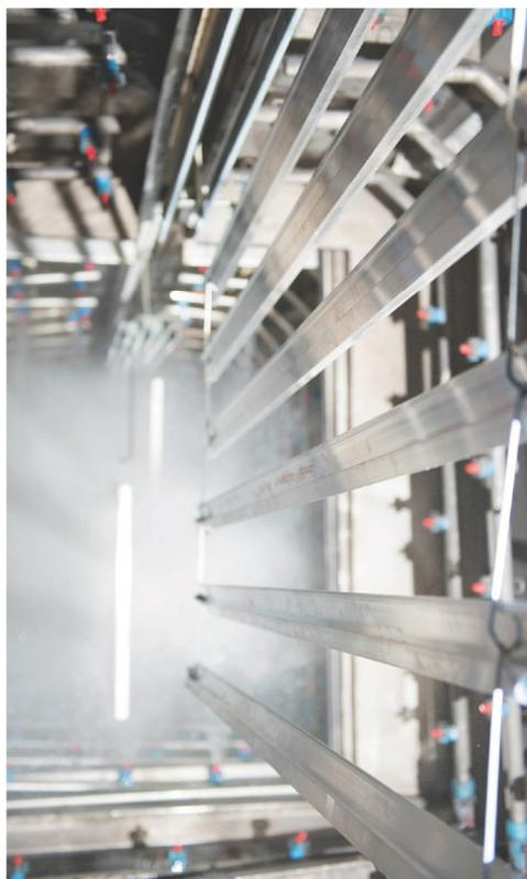
Ein Ausführungsbeispiel: In dieser Anwendung ist die Spritzvorbehandlung als Tunneldurchlaufanlage ausgeführt.
