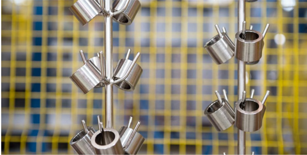
Die Bestückungsdichte des Warenträgers bietet meist einen Ansatz zur Optimierung. Foto und Grafik: Qubus
