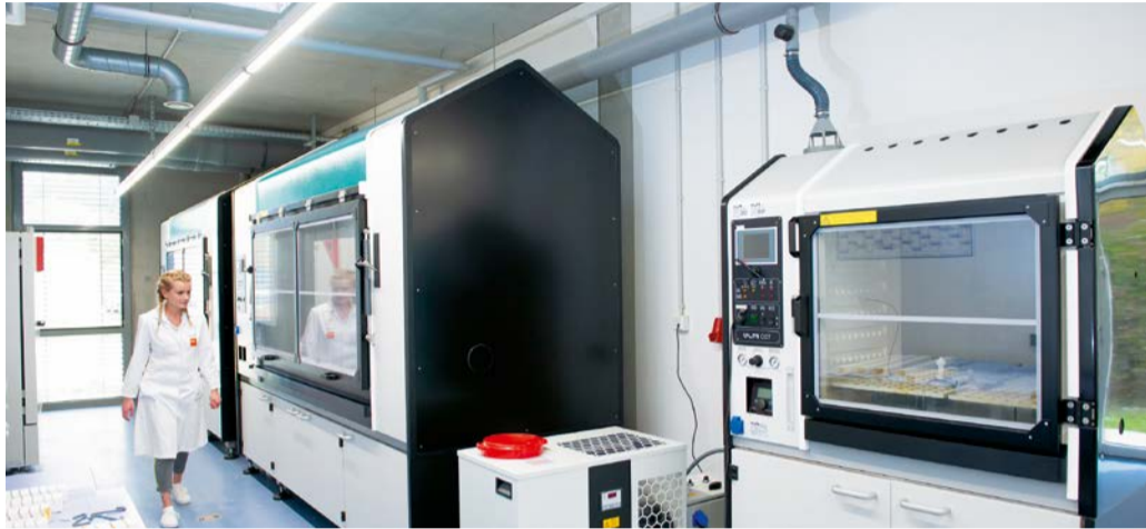
Das IFO-Labor ist mit unterschiedlichen Korrosionsprüfkammern ausgestattet. Dadurch kann der Dienstleister auf kundenspezifische Bauteilanforderungen eingehen und Korrosionsprüfungen entsprechend der Größe der Bauteile oder dem benötigten Volumen anbieten. Fotos: IFO
